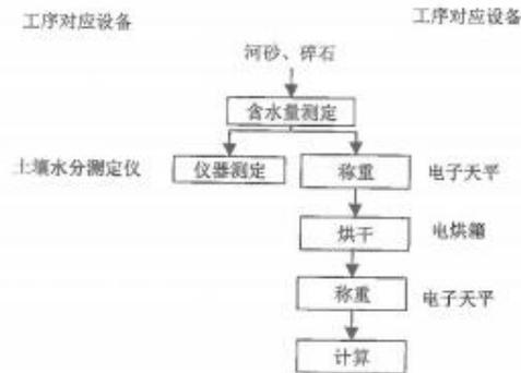
图5 砂石含水量测定流程图
