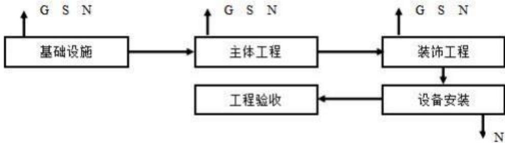
图2-1 施工流程图
