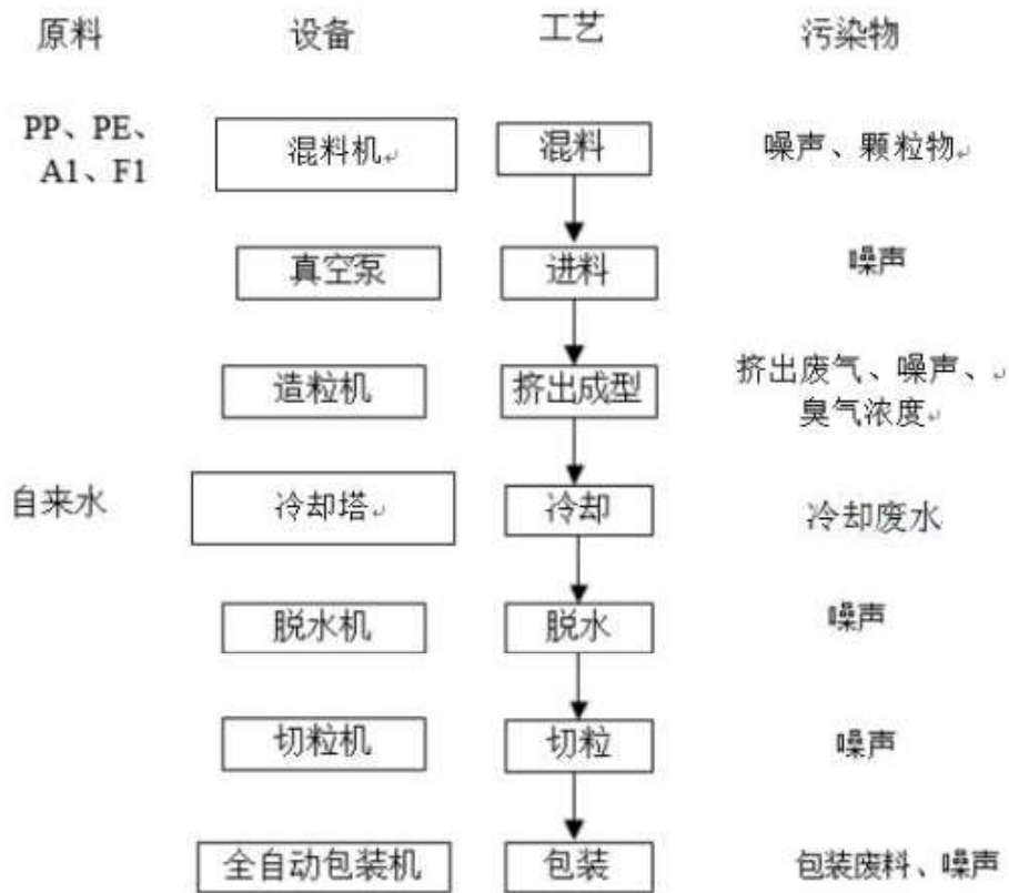
图 2-3 拉条造粒工艺流程及产污环节图
