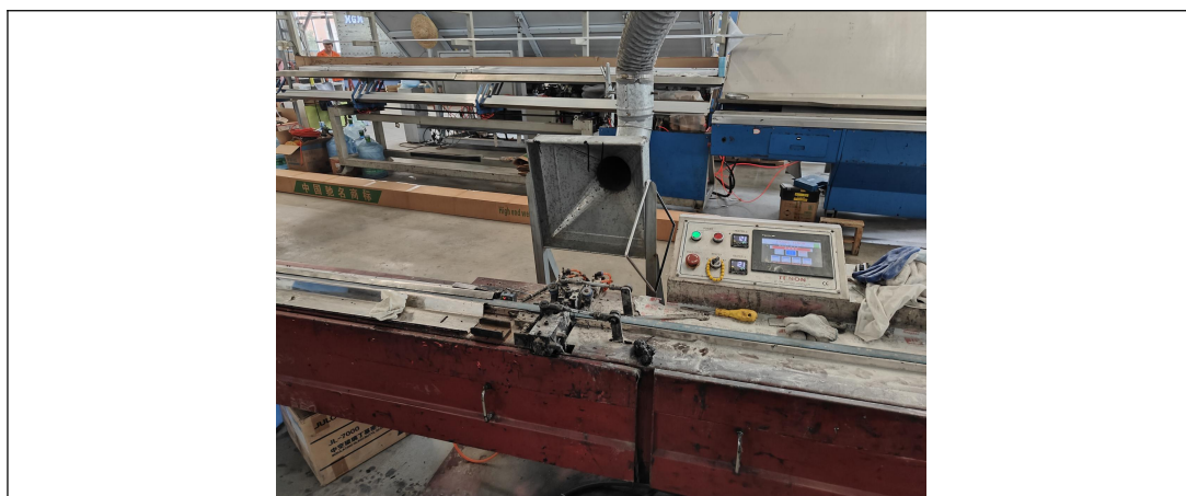
中空玻璃涂丁基胶-涂胶上方设置集气罩
