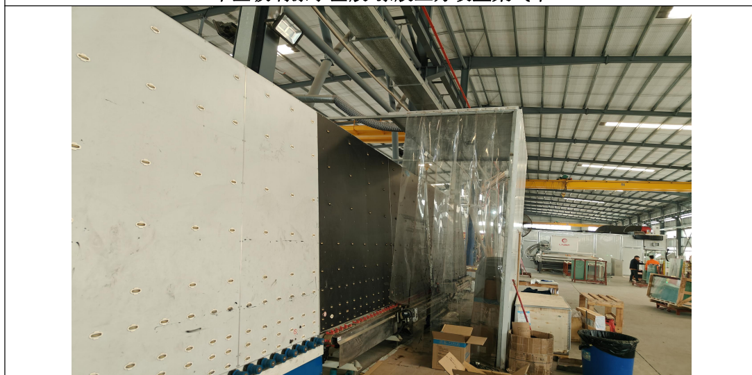
中空玻璃涂密封胶-设置垂帘围挡，采用上吸式吸风口抽风收集
