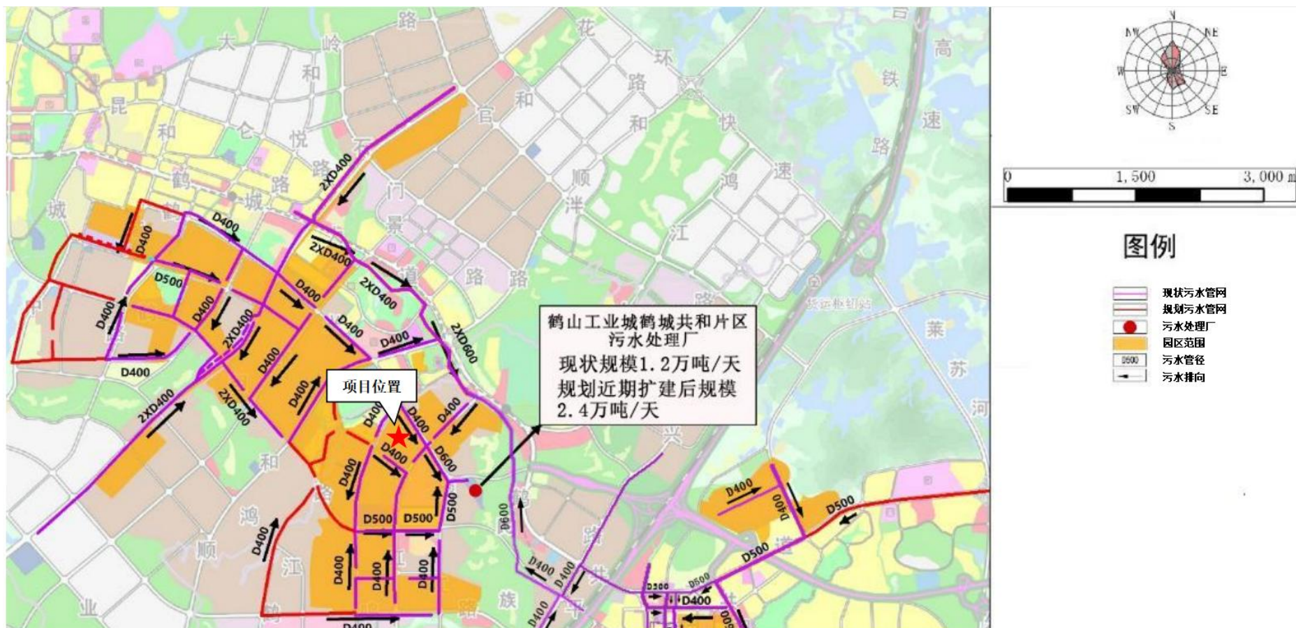
附图 12 鹤城共和片区污水处理厂纳污管网图
