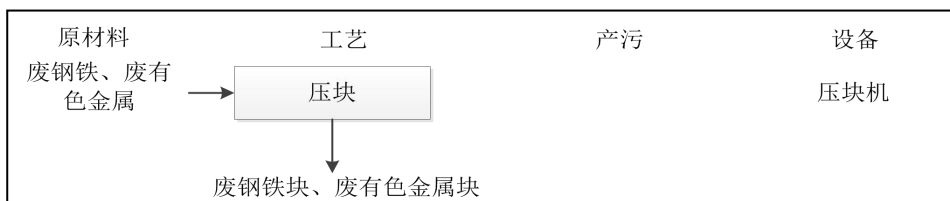
图2-5 废旧钢铁压块工艺流程及排污节点图
