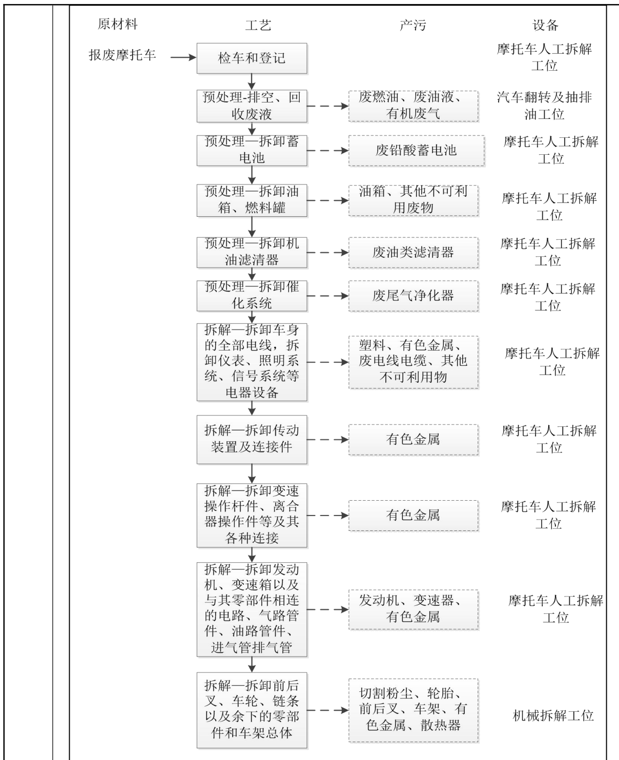
图2-3 报废摩托车预处理和拆解工艺流程及排污节点图
