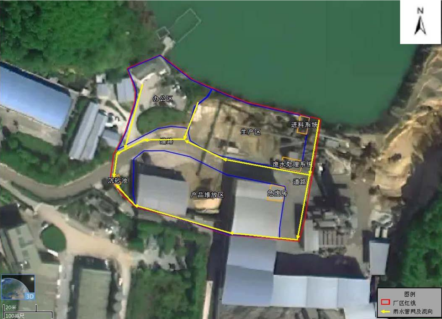
附图 10 厂区雨水管网及流向图
