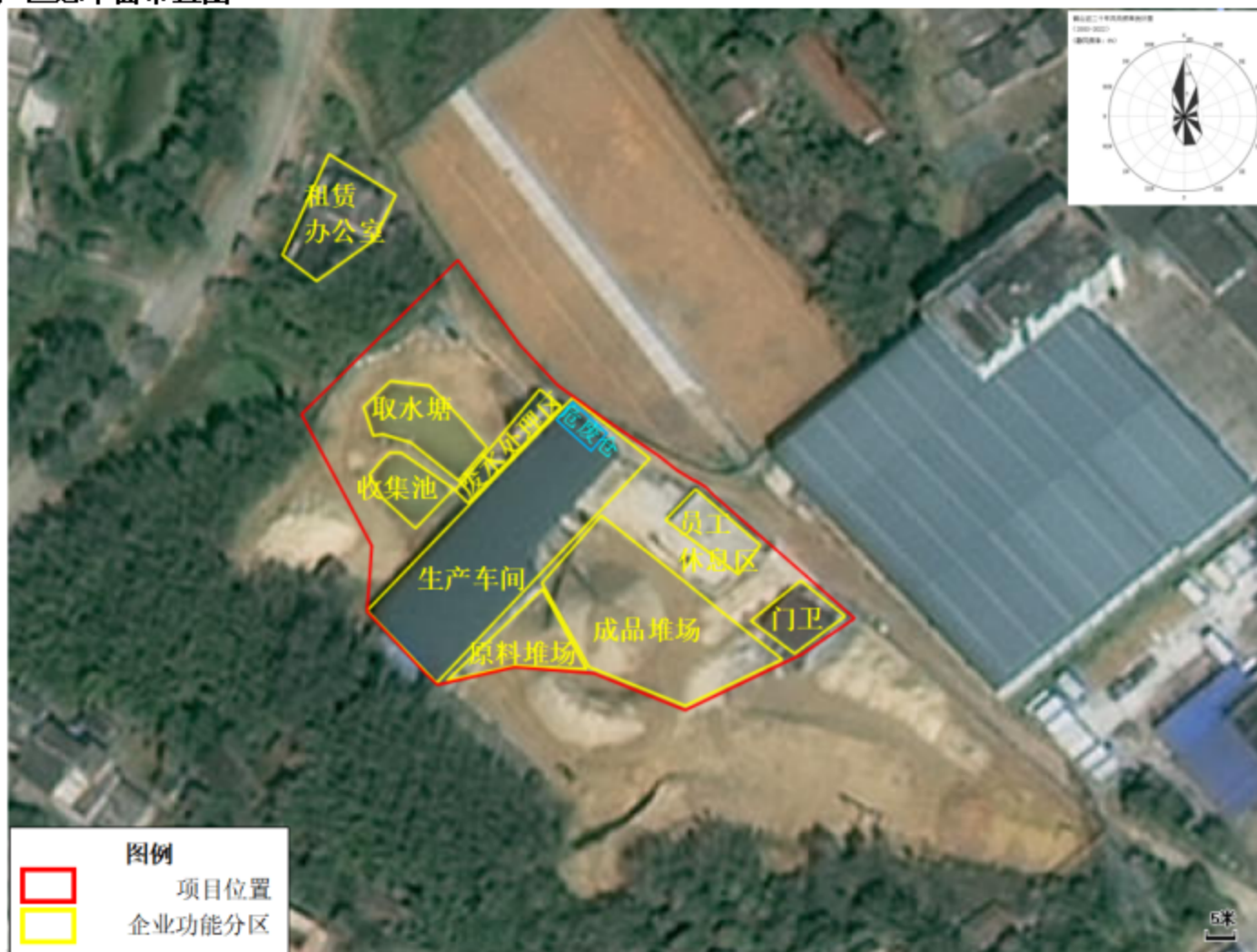
附图 3 项目厂区总平面布置图
