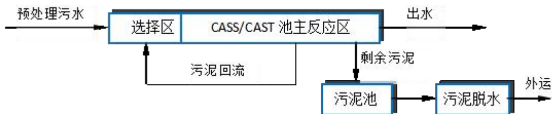
图 3.2-1 CASS/CAST 工艺基本流程
