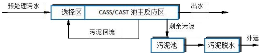
图 3.2-1 CASS/CAST 工艺基本流程
